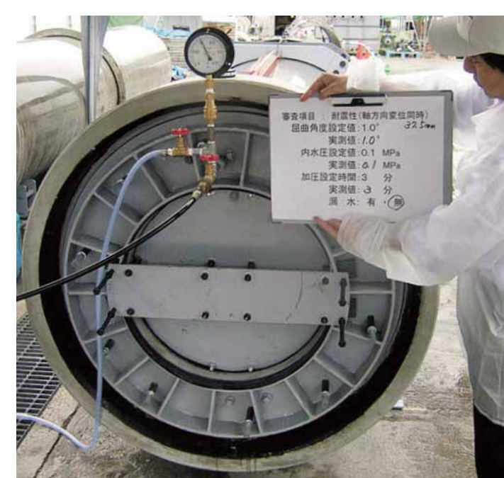
漏水確認状況
